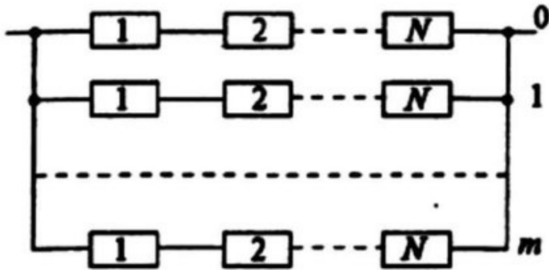
Общее резервирование с постоянно включенным резервом
