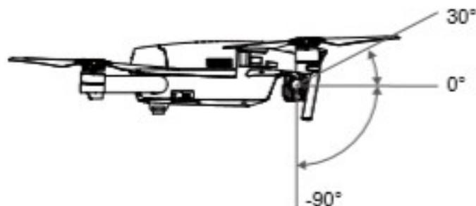
С помощью диска управления подвесом на пульте ДУ управляйте наклоном камеры или перейдите к пункту «Camera View» в приложении DJI GO 4, коснитесь экрана и удерживайте его, пока не появится синий круг, затем перетащите круг, чтобы управлять наклоном камеры. Управляемый диапазон оси подвеса камеры составляет от 0° до 90°, что позволяет снимать в ландшафтном и портретном режимах. При включенном портретном режиме ось вращения будет повернута на 90°.
