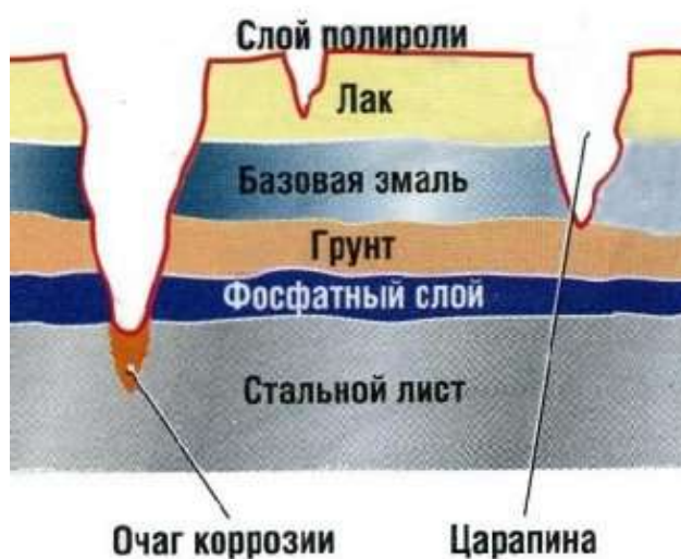
Рис. 3.8. Воздействие коррозии на кузов
