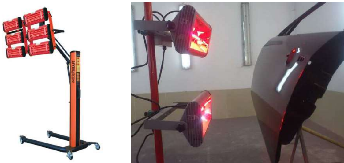
Рис. 2.40. Различные модели мобильных сушильных установок
