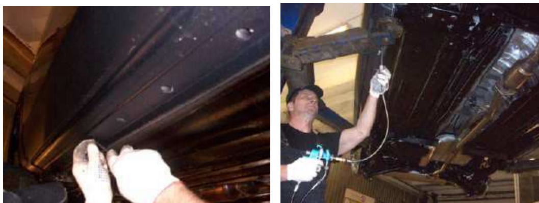
Рис. 3.12. Этап обработки скрытых полостей
