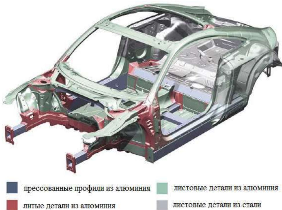
Рис. 1.1. Структура современного кузова
