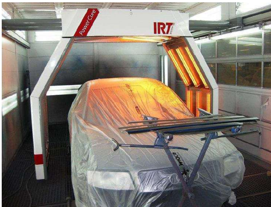
Рис. 2.39. Камера для сушки автомобиля после покраски с сушильной установкой портального типа
