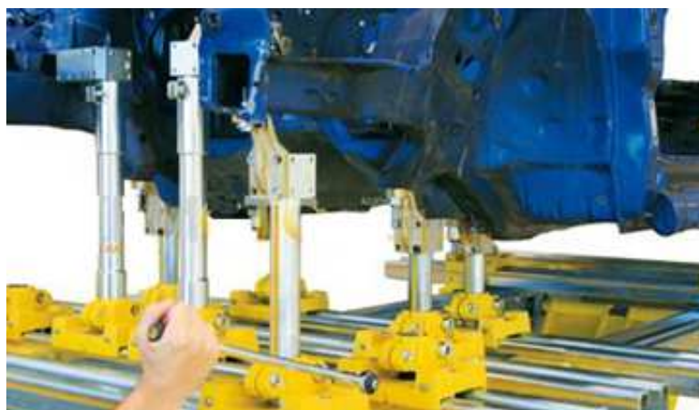
Рис. 1.14. Шаблонная измерительная система
