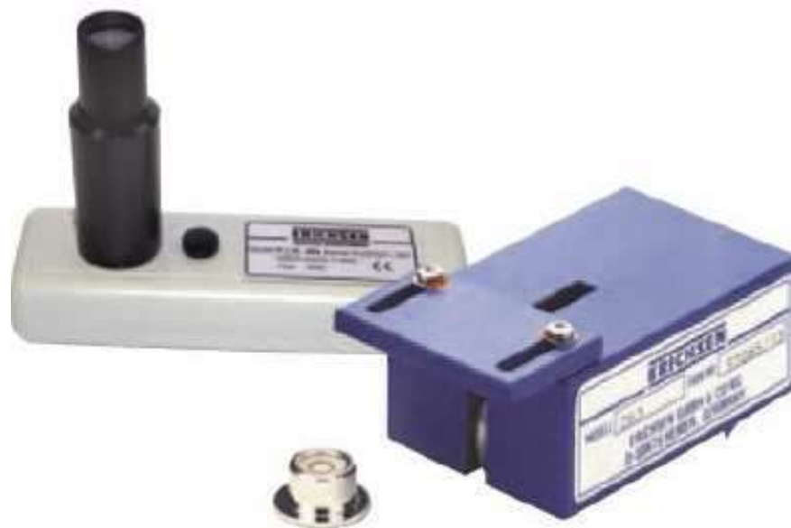
Рис. 2.83. Твердомер по Бухгольцу
