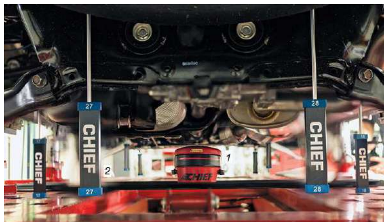
Рис. 1.19. Лазерная измерительная система CHIEF GENESIS VECTOR: 1 - лазерный сканер, 2 - зеркала
