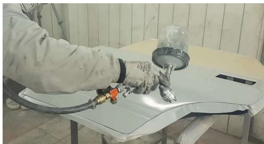
Рис. 2.9. Нанесение жидкой шпатлевки
