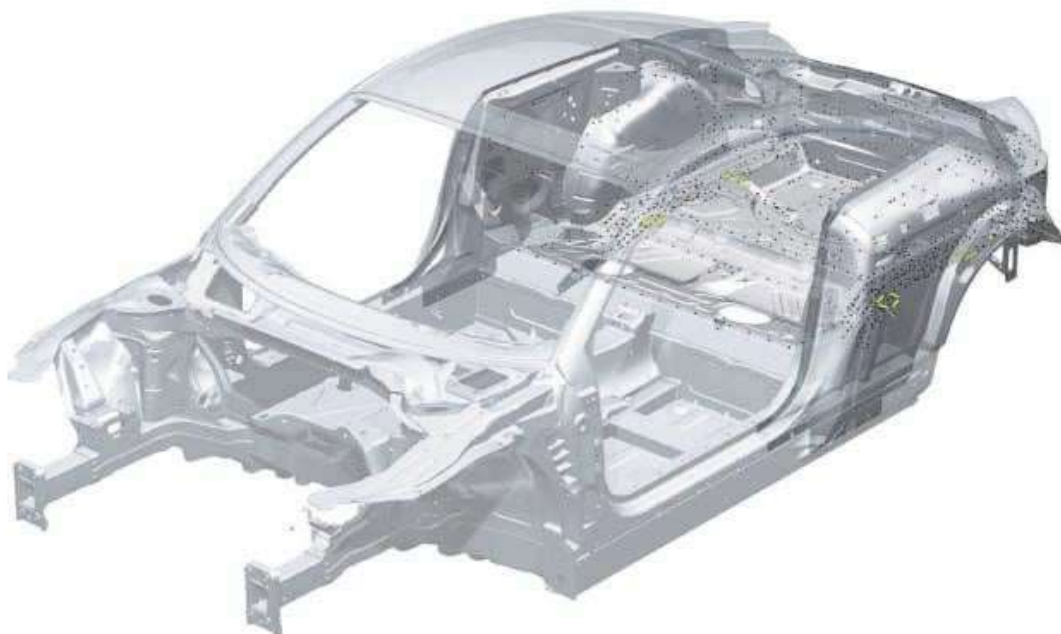
Рис. 1.9. Точки применения точечной сварки
