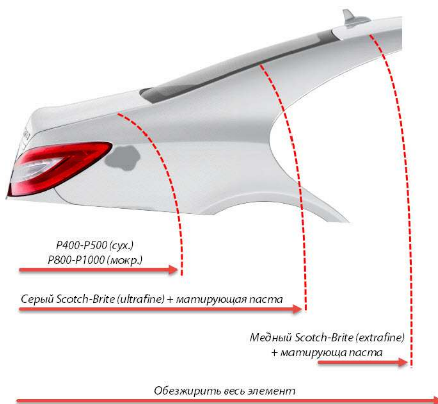
Рис. 2.46. Подготовка под покраску переходом
