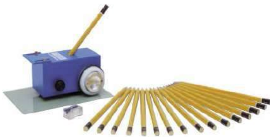
Рис. 2.82. Карандашный метод проверки твердости
