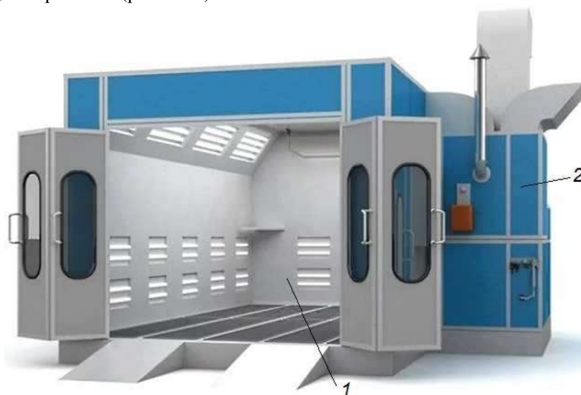
Рис. 2.37. Окрасочно-сушильная камера для легковых автомобилей: 1 – камера; 2 – блок обеспечения функционирования
