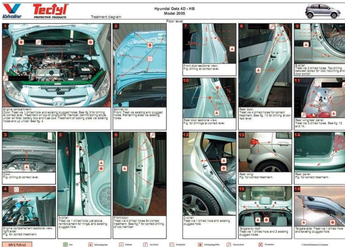
Рис. 3.11. Схема обработки скрытых полостей
