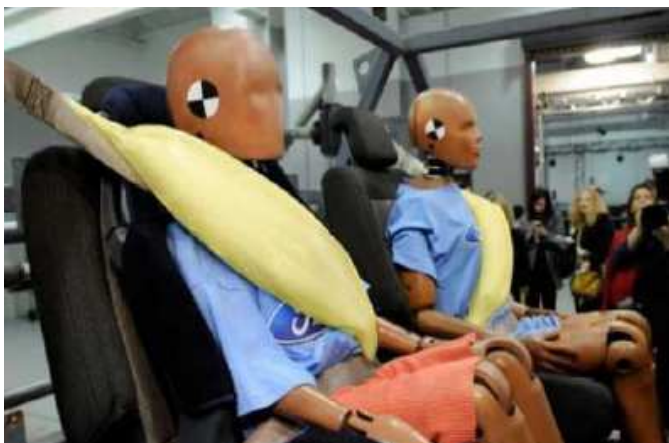
Рис. 3.20. Ремни безопасности со встроенными надувными элементами
