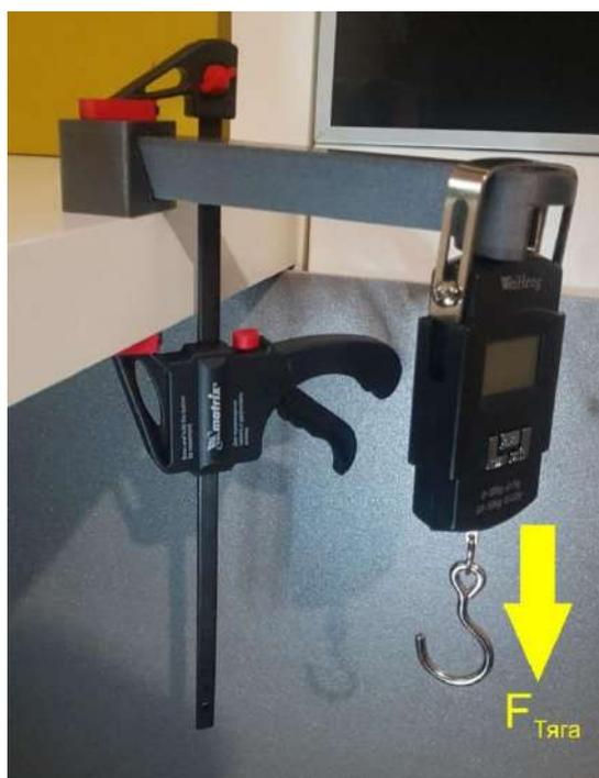
Рис. 4. Стенд для испытания на прочность луча
