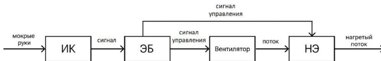
**Рис. 2. Функциональная схема сушилки для рук:**
