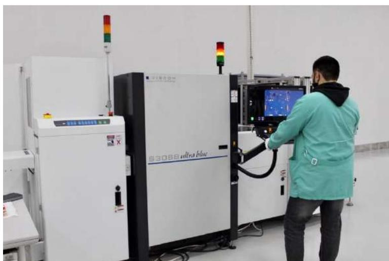
**Рис. 4. Контроль качества монтажа компонентов на установке VISCOM S3088**
