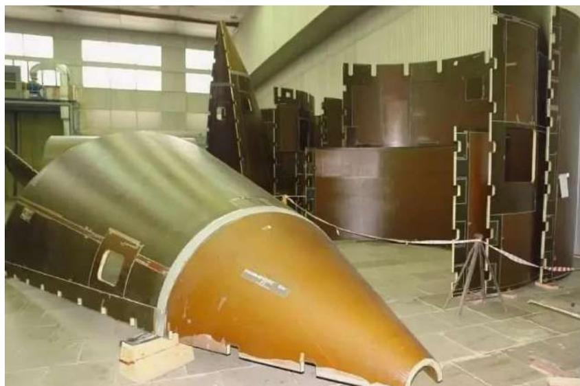
**Рис. 2. Ракетный обтекатель из ККМ**
