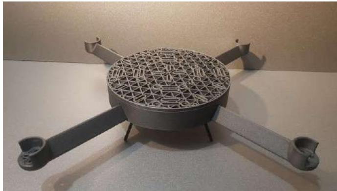
Рис. 2. Спроектированная и напечатанная платформа БПЛА
