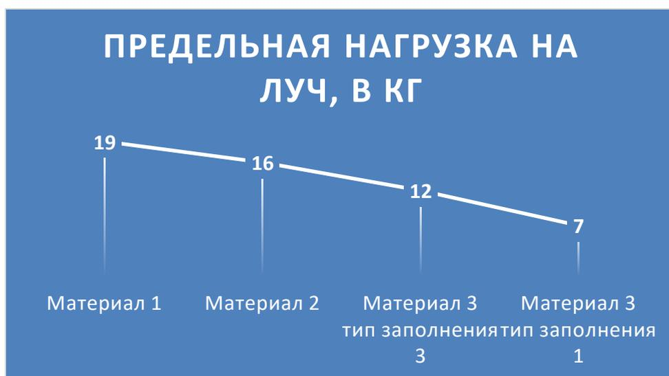
**Рис. 6. Величина нагрузки для разрушения образца**
