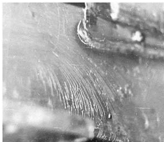
Картина трещин в хрупком лаковом покрытии, нанесенном на боковину лонжерона подмоторной рамы, полученная при закручивании кузова
