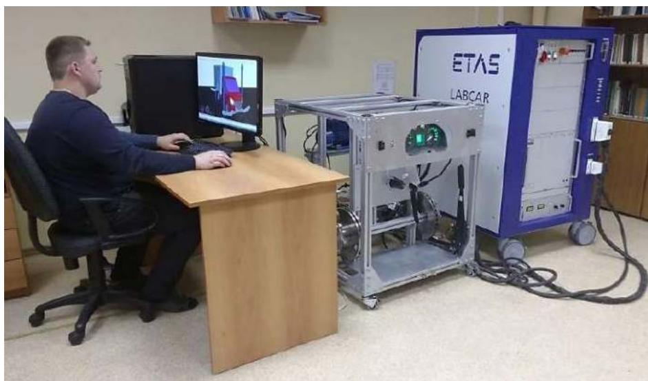
Программно-аппаратный комплекс для проведения виртуально-физических испытаний легких коммерческих автомобилей, оснащенных ЭКУ
