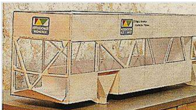
Масштабный (1:10) бумажный макет кузова автобуса типа «монокок» для экспериментальной проверки кососимметричных деформаций кузова и его основных проемов и проверки их соответствия результатам расчетов
