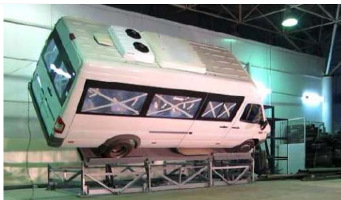
Стендовые испытания кузовов автобусов на боковое опрокидывание
