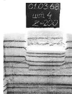
Картина деформации снежного покрова под штампом
