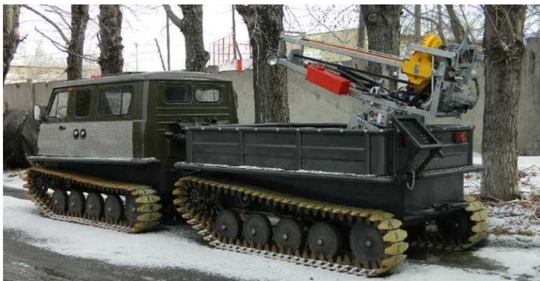
Двухзвенный (сочленённый) снегоболотоход «Унжа» на пластиковой (армированный полиуретан) гусенице с буровой установкой (разработка НИЛ «ТМиТТК» и ЗВМ)
