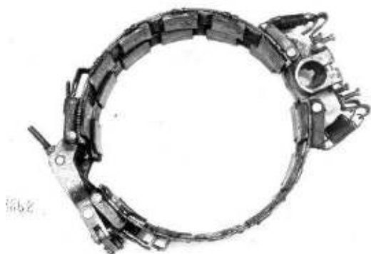
Грошев А.М. и доработанные по его рекомендациям тормозные ленты механизмов поворота гусеничных машин Горьковского автозавода
