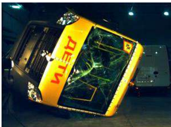
Стендовые испытания кузовов автобусов на боковое опрокидывание
