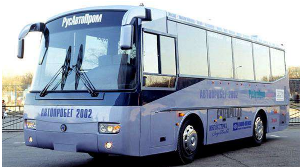
Подготовленный к испытательному пробегу ПАЗ-4230 «Аврора» с двигателем «Катерпиллер» – дальнейшее развитие модели автобуса ПАЗ-4223 «Аврора»
