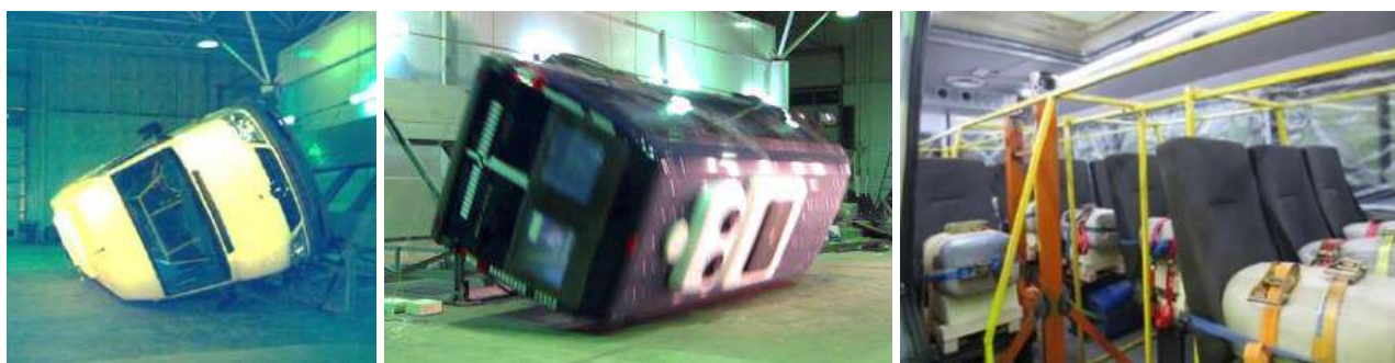
Фрагменты натурных исследований кузовов автомобилей на безопасность
