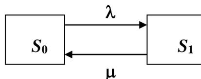
**Рис. 5.2. Размеченный граф состояний одноканальной СМО:**
