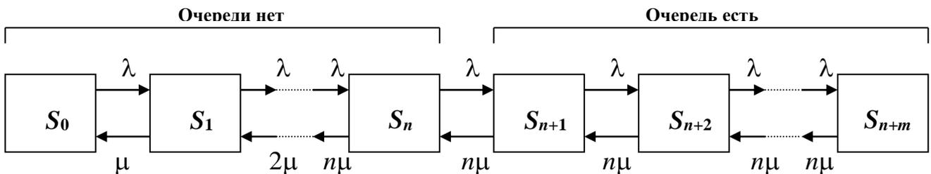
Рис. 5.6. Граф состояний  $n$ -канальной СМО с ограничением на длину очереди  $m$
