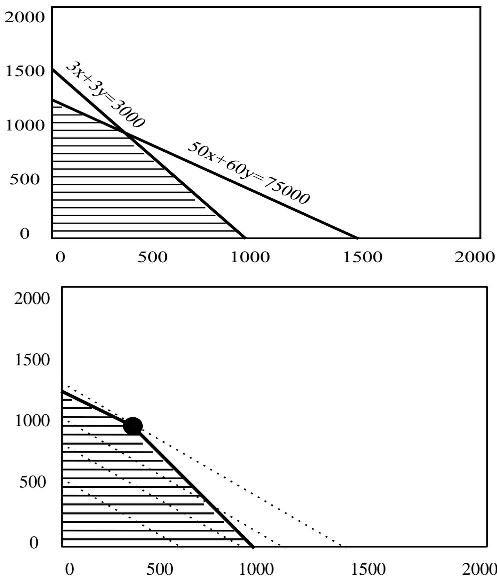
Рис. 4.1. Пример графического решения задачи линейного программирования
