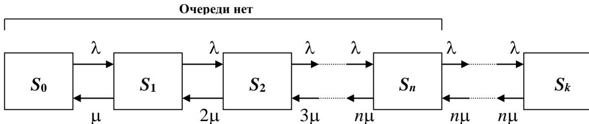
Рис. 5.7. Размеченный граф состояний многоканальной СМО с неограниченной очередью
